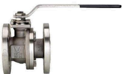
Полнопроходной шаровой кран, нержавеющая сталь, фланцевое присоединение, пожаробезопасный, с антистатическим устройством, размеры по DIN 3202F4/F5
