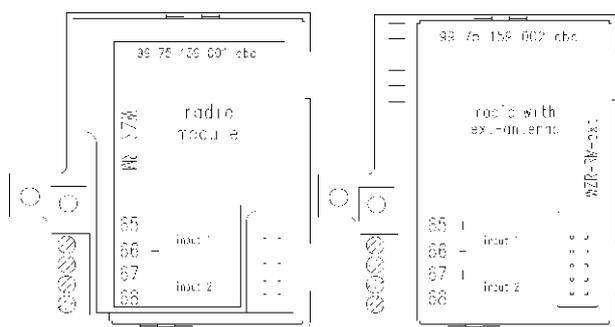
радиомодуль с интегрированной антенной позволяет осуществлять дистанционное считывание на расстоянии до 100 м. Для особых условий монтажа может применяться радиомодуль с внешней антенной.
