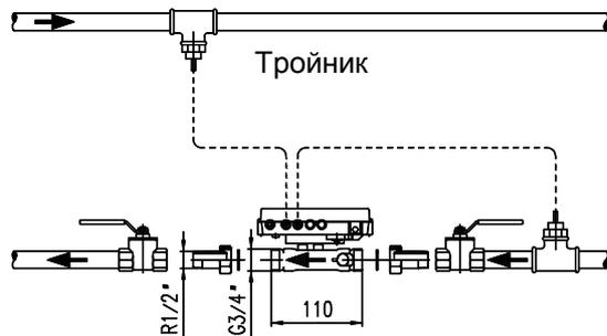
Пример монтажа в шаровом вентиле
