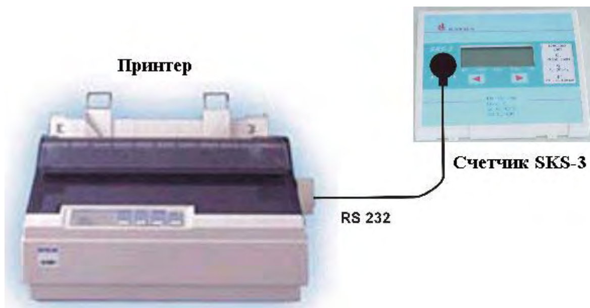
Рис. 8.6. Подключение принтера через оптопорт.
