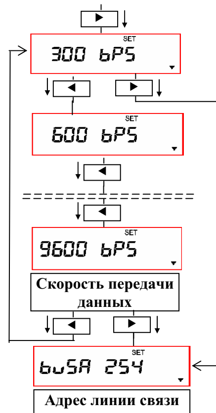
Рис.7.4. Порядок ввода параметров, помеченных двумя звездочками “**” (напр.: выбор скорости передачи данных)
