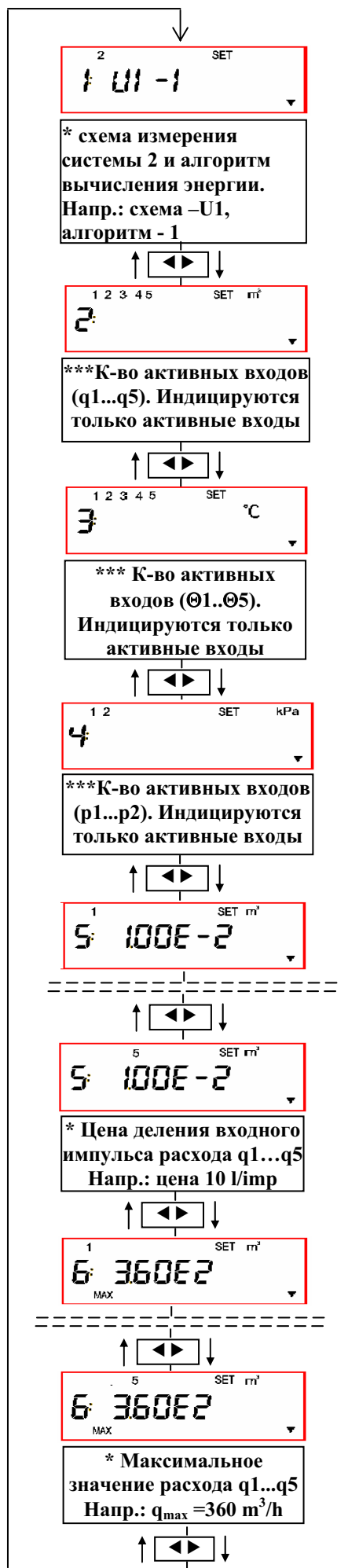
Рис.7.2. Схема ввода настроечных параметров при конфигурации счетчика.
