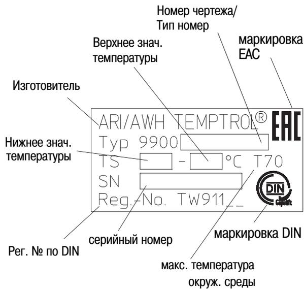
Рис. 3: Терморегулятор
