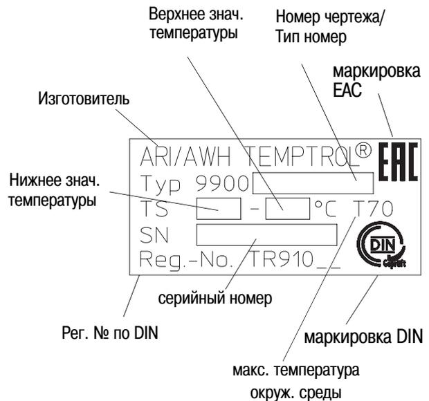
Рис. 4: Термореле
