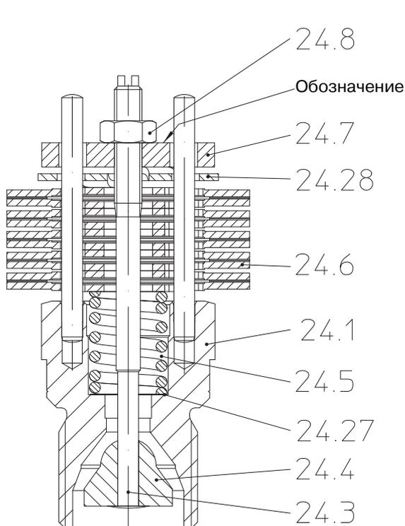
Рис. 10: Бимет. регулятор PN16-100 /
