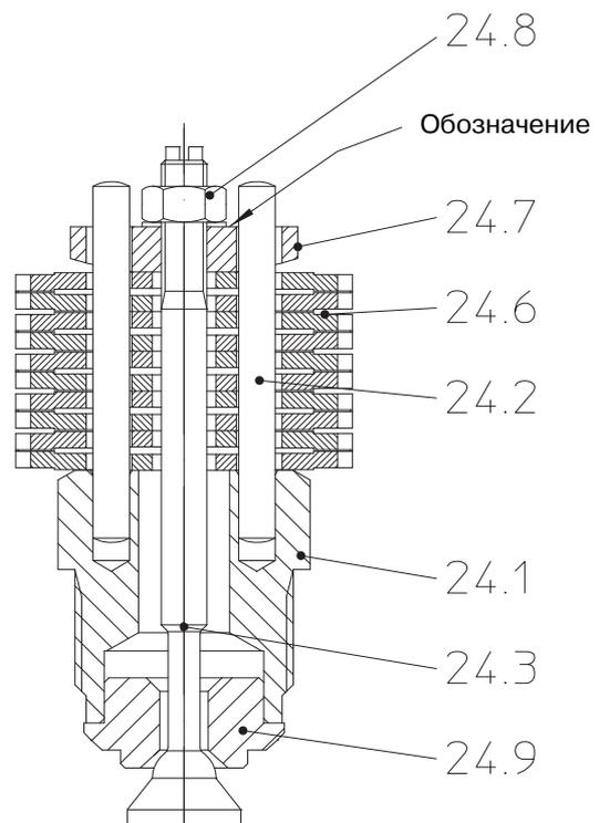
Рис. 11: Бимет. регулятор PN160-630 /
